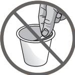
4. Placez une capsule K-Cup® dans le support à capsule K-Cup® (fig. 10). **ATTENTION : La capsule K-Cup® est perforée par deux aiguilles, une au-dessus et l'autre au fond du support à capsule K-Cup®. Pour éviter tout risque de blessure, ne pas mettre les doigts dans le boîtier du support à capsule K-Cup®.**
