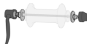
図 1.ハブに取り付けられたワッシャー付きクイックリリース
