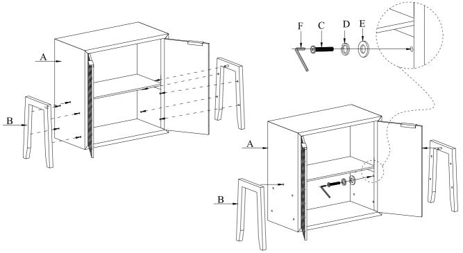
NOTE: 1.THE FURNITURE TIPPING RESTRAINT IS STAPLED TO THE BACK OF THE UNIT. 2.STRAIGHT ALLEN KEY(H)IS FOR USE WITH A POWER DRILL.
